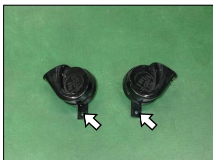
取付け穴を 8~8.5mm に拡大する。
