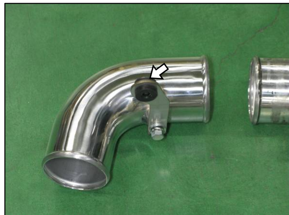
純正 V/C のグロメットを外し、ブラケットに取付ける。
