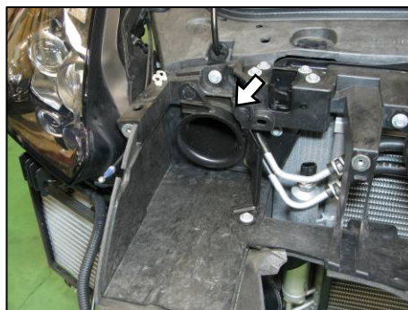
エアファンネルを取外す(左右)
